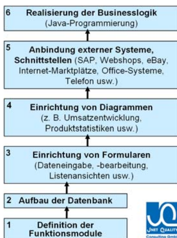
Bild 1: Typischer Ablauf von Integrationsprojekten betriebswirtschaftlicher Systeme. EDC kürzt die Schritte 3 bis 5 ab.
